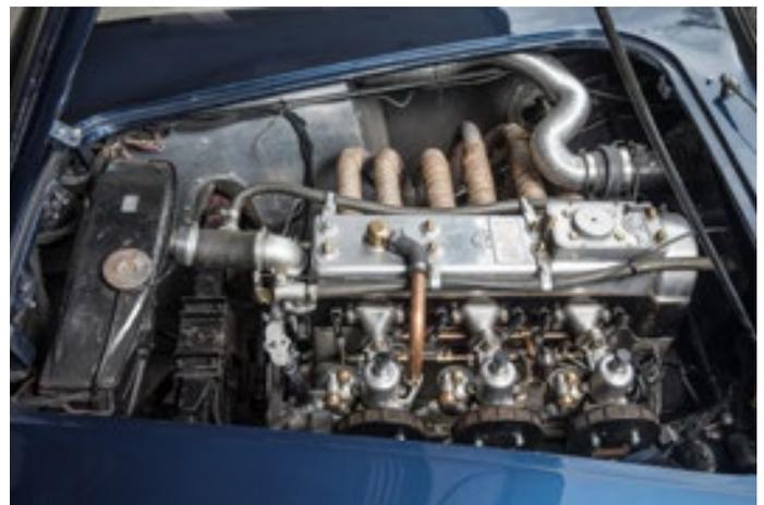
Restaurierungs-Arbeiten. Dabei wurden viele Bereiche an diesem Fahrzeug komplett neu gemacht: Motor / Getriebe, Differential, Elektrische Anlage, Tank u.v.m. Damit konnte der AC auf dem Strassenverkehrsamt die Prüfung bestehen und mit dem Code 180 als Veteran zugelassen werden.
